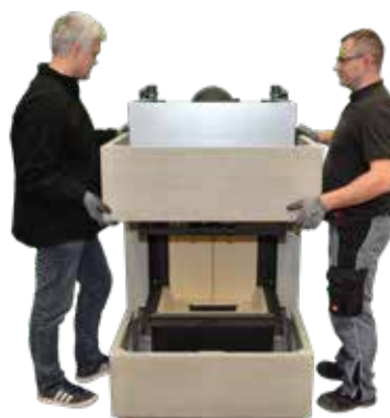
18. Erstes Oberbauteil ohne zu Verkleben mit der Falzseite von oben auf den Tragrahmen setzen und ausrichten. Tragrahmen ggf. nachstellen.
