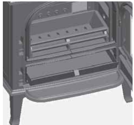
Abb. 4.12 Entnehmen des Aschekastens
