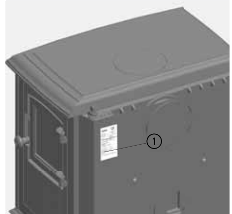
Abb. 7.1 Geräteschild / Typenschild auf der Geräterückseite
