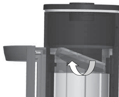
Abb. 4.19 Entnahme des Umlenksteins durch seitliches Anheben und anschließendem Herausschwenken
