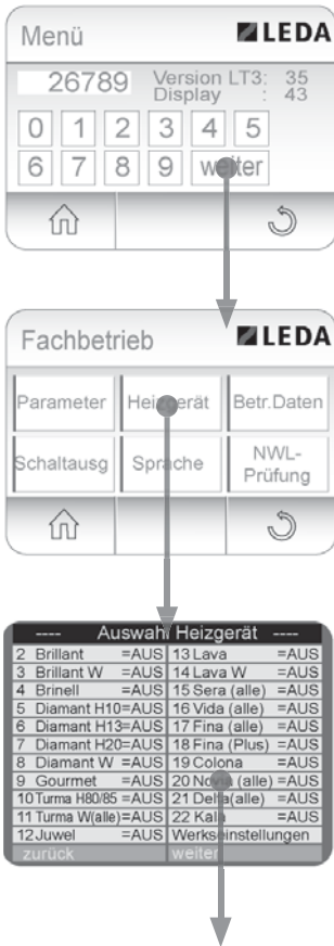
Abb. 3.28 Zugriff auf die Heizgeräte-Ebene
