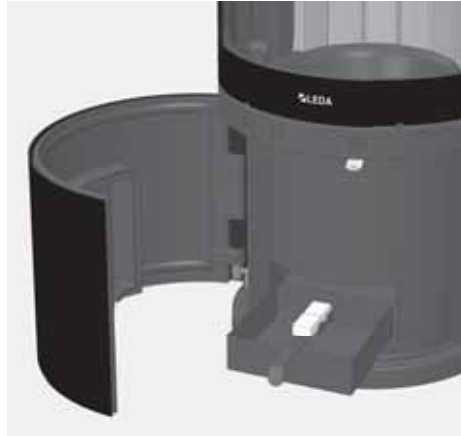
Abb. 4.7 Anzündhilfe im dafür vorgesehenen Halter auf dem Aschekasten
