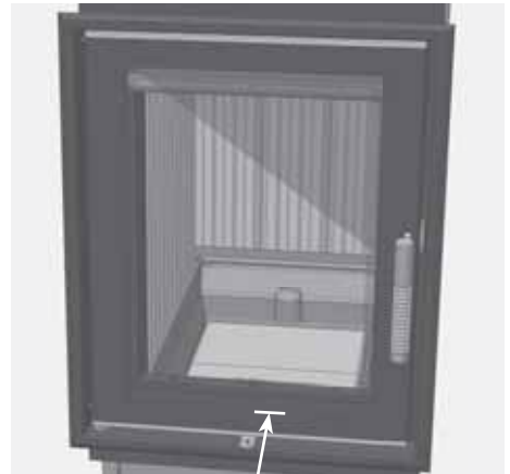
Abb. 3.8 Verbrennungsluftschieber ganz eingeschoben
