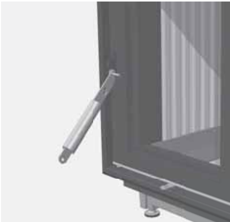
Abb. 3.2 Türverschluss und Bediengriff („kalte Hand“)
