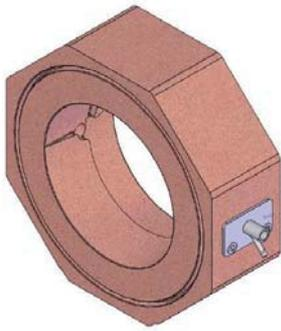
MSS mit Anschlusspunkt für Thermoelement und Unterdruckschlauch
