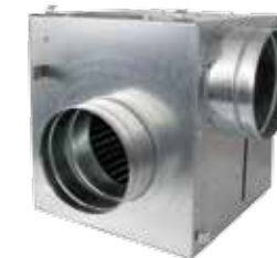
Ventilator / Ventilatorbox Der Ventilator ist ein Langsamläufer. Er ist thermisch und schalldicht montiert, in einer Box aus verzinktem Blech mit Luftstutzen und Zuführkabel. Er bewegt die Warmluft innerhalb der Hypokaustenanlage und ist mit einem Thermostatsfühler versehen.
