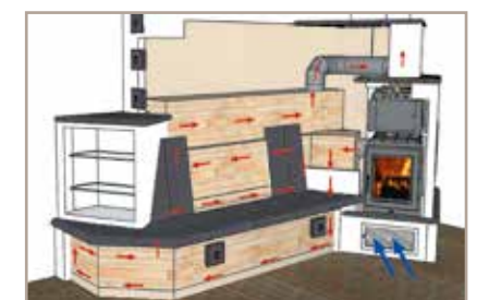
Mit Heizwasser-Aufsatzregister (für die Anbindung an das Heizungssystem) und keramischem Zug.
