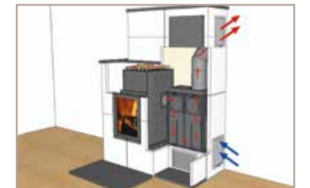
Kombi-Speicher-Kamin (mit Anbindung an das Heizungssystem) und Nachheizkasten.
